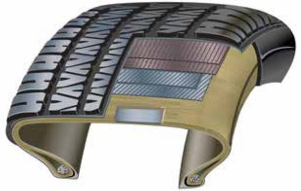
**Flanc du pneumatique ou épaulement** : protège les nappes des agents atmosphériques et chimiques et s'oppose également à la flexion à laquelle il est soumis lors de son utilisation.
