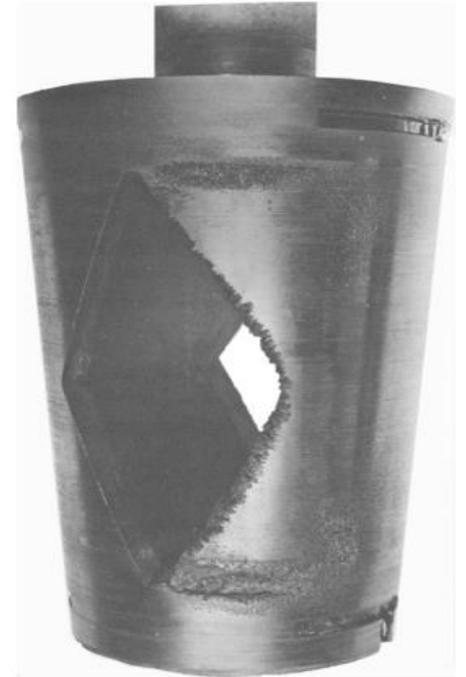
bre as causas deste processo. Uma primeira teoria sobre a evolução do processo erosivo prevê que, quando a bolha isolada implode numa região de fluido afastada das paredes, o seu colapso ocorre simetricamente. O fluido envolvente tende a ocupar rapidamente as regiões livres do colapso da bolha. Este movimento do fluido induz uma onda de pressão de alta intensidade que é transmitida rapidamente através do líquido circundante.
